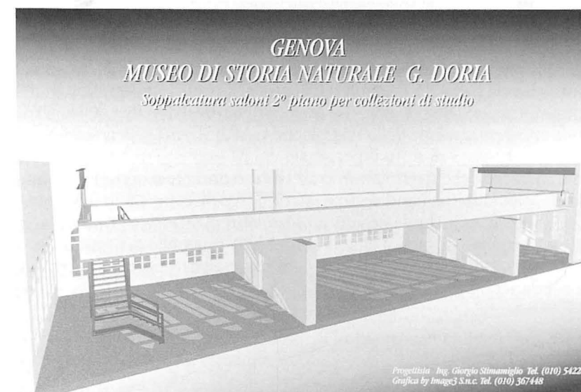
Fig. 4 - Prospetto assonometrico del soppalco in corso di realizzazione per il secondo piano (I° stralcio).
